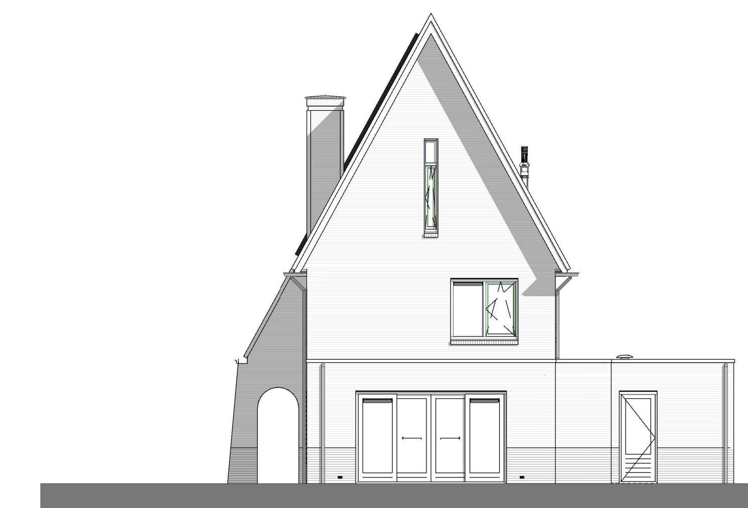
bouwnummer(s) get. 271 en 281 achtergevel - uitbouw 1200 / 2400 + schuifpui
